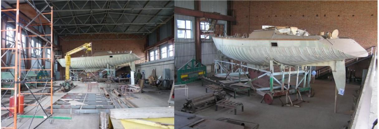
Сверхлегкий материал корпуса. В качестве материала корпуса использовались стеклоламинаты на основе эпоксидных смол, без применения отвердителей, что обеспечивает экологическую чистоту корпуса и, следовательно, внутренних помещений.
